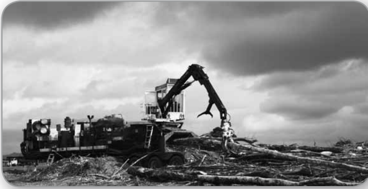
↑ Mobiler Schredder verarbeitet Baumstämme ↓ direkt zu Holzchips ↓
