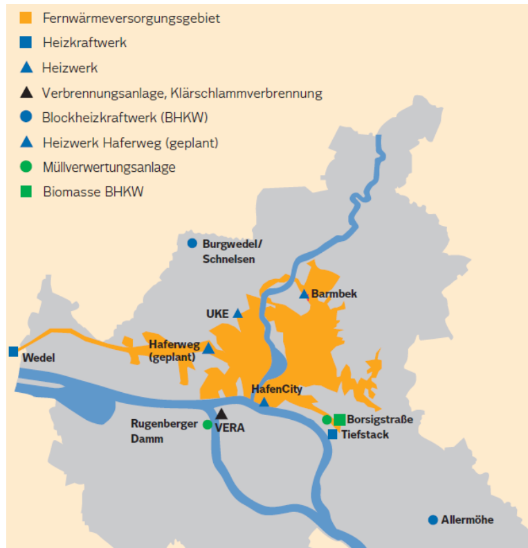
Bild A3.5: Fernwärmeerzeugungsanlagen von Vattenfall in Hamburg (Quelle: Vattenfall 2014)
