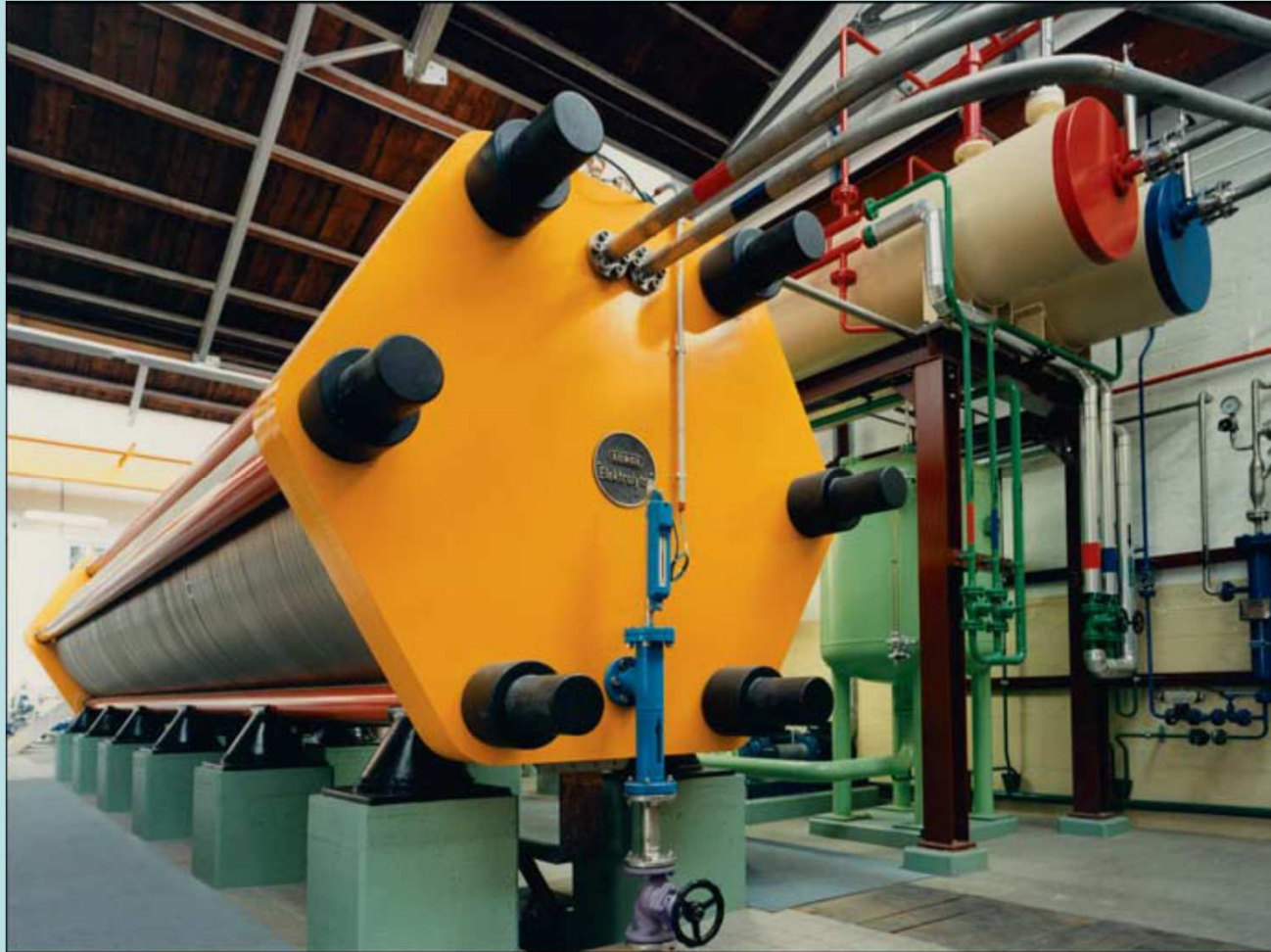
Moderner 30 bar – Druckelektrolyseur der Firma Elektrolyse-Technik GmbH mit einer Kapazität von 760 \text{ m}^3/\text{h} ( \sim 3,5 \text{ MW}_{\text{el}} ); Foto: ELT GmbH
