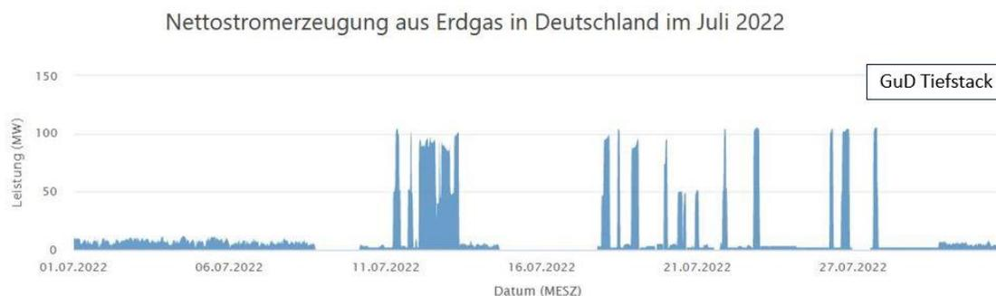
**Bild 5:** Stromleistung des GuD Tiefstack im Juli 2022. Kurze Zeitintervalle mit hohen Leistungen und sehr geringe Leistungen im Rest der Zeit (Datenquelle: [Energy Charts der Fraunhofer ISE](#))
