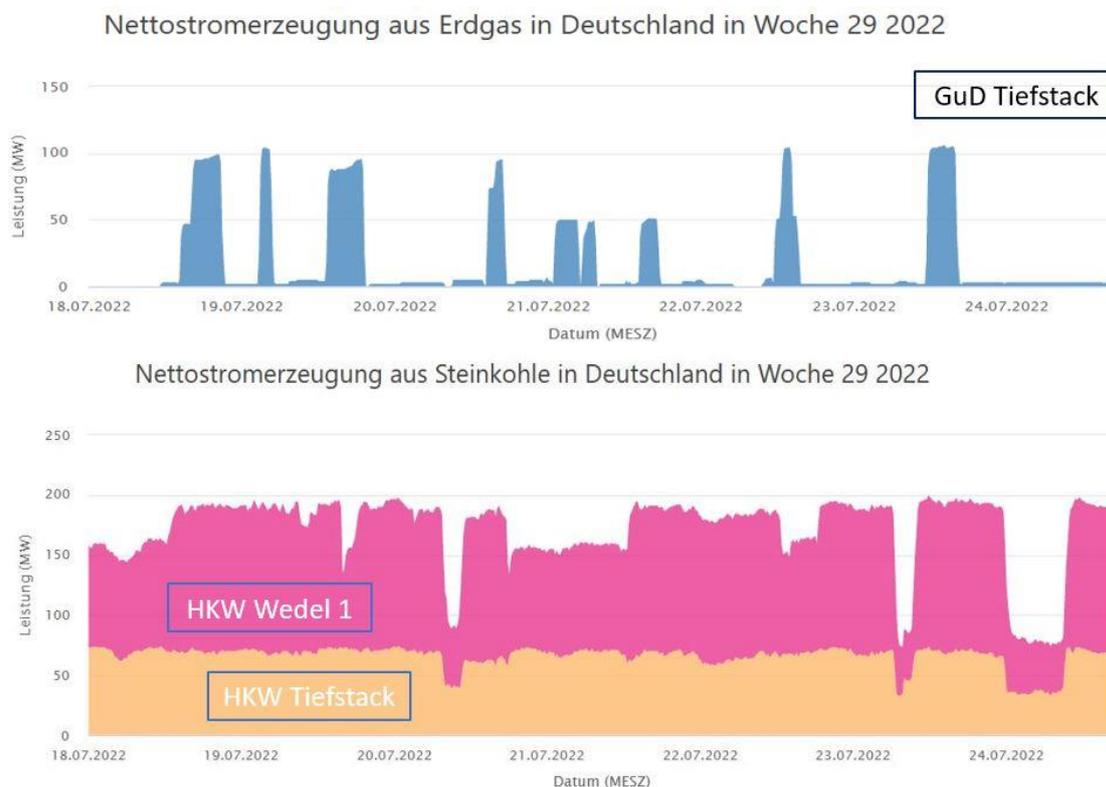
**Bild 7:** Zeitlicher Zusammenhang zwischen der Stromerzeugungsleistung des GuD Tiefstack (blau) und den Stromerzeugungsleistungen der Heizkraftwerke Tiefstack und Wedel 1 in der 29. Woche des Jahres 2022 (Wedel 2 in dieser Woche ohne Stromproduktion). (Datenquelle: [Energy Charts der Fraunhofer ISE](#))
