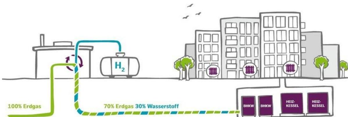
**Bild 5:** Bei 30 Vol.-Prozent Wasserstoff ist der energetische Anteil nur 10,7 Prozent (Bildquelle: [Gasnetz Hamburg](#))
