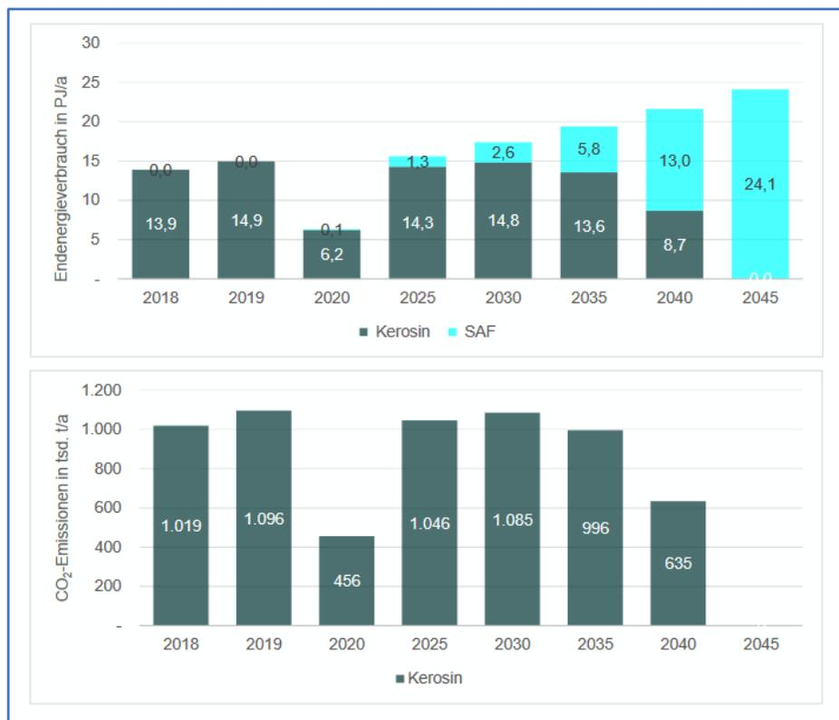
**Bild 12:** Endenergieverbrauch und CO<sub>2</sub>-Emissionen des Luftverkehrs international und national in Hamburg ([Szenario B](#), Seite 140). Um CO<sub>2</sub>-Neutralität im Jahr 2045 zu erreichen, wird ein sehr starkes Wachstum eines „CO<sub>2</sub>-neutralen“ Ersatzes für Kerosin angenommen (hellblau). (SAF = Sustainable Aviation Fuels)
